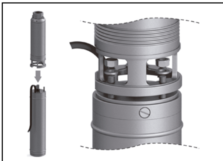
Figura 2 – Acoplamento do conjunto submerso
