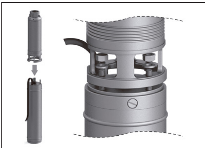
Figura 2 – Acoplamento do conjunto submerso
