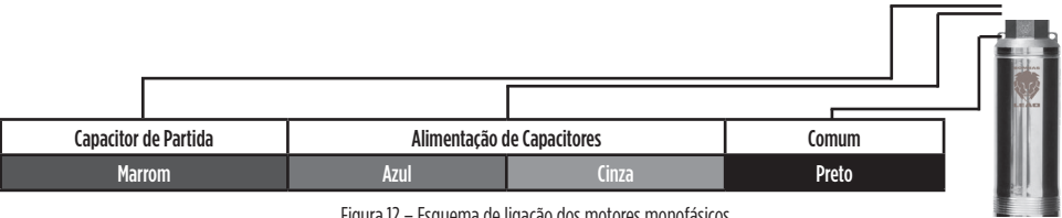
Figura 12 – Esquema de ligação dos motores monofásicos
