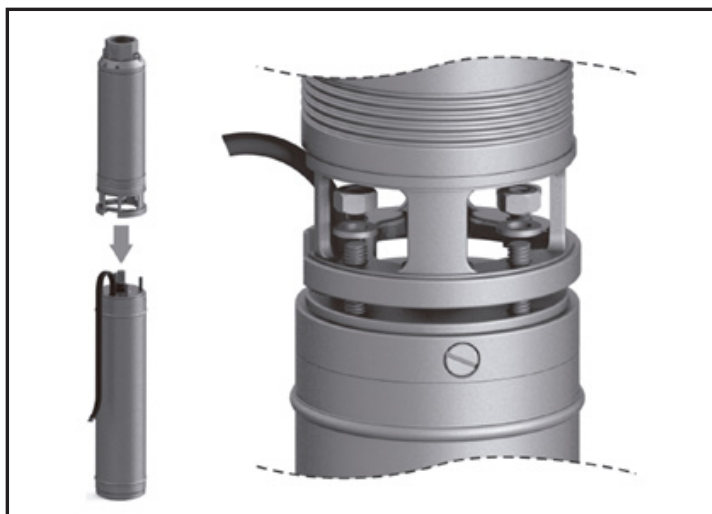
Figura 2 – Acoplamento do conjunto submerso
