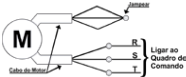
Figura 14.4 B: Esquema de ligação motor dupla tensão em 380V
